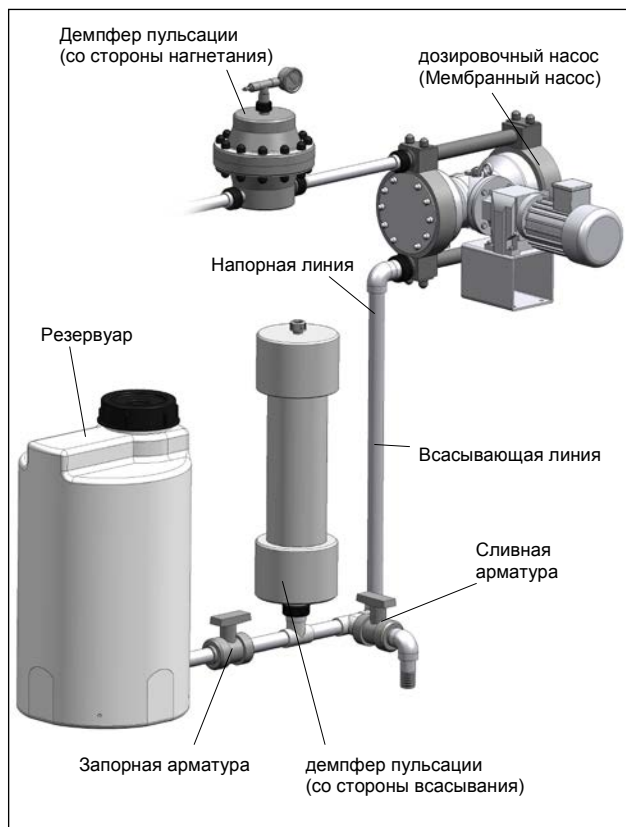
Рис. 29 Монтаж демпфера пульсации (III)
