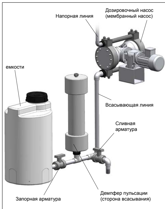
Рис. 28 Монтаж демпфера пульсации (II)
