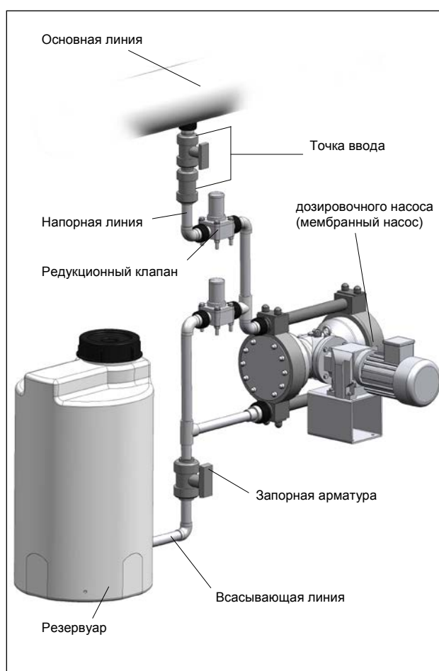
Рис. 20 Монтаж редукционного клапана
