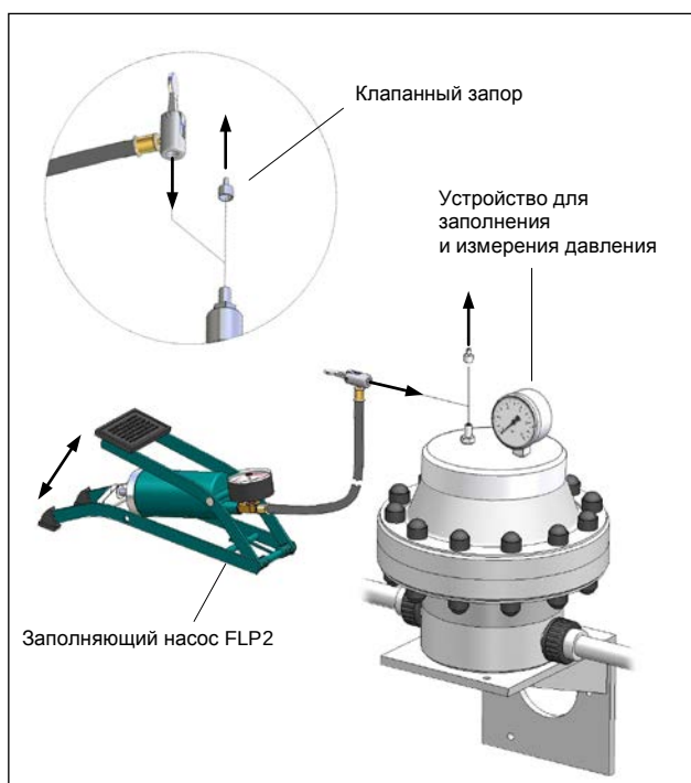
Рис. 17 Подсоединение заполняющего насоса FLP2
