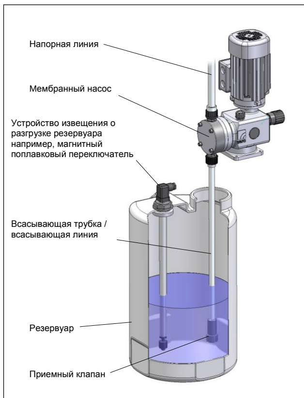
Рис 29 Монтаж устройства извещения о разгрузке резервуара
