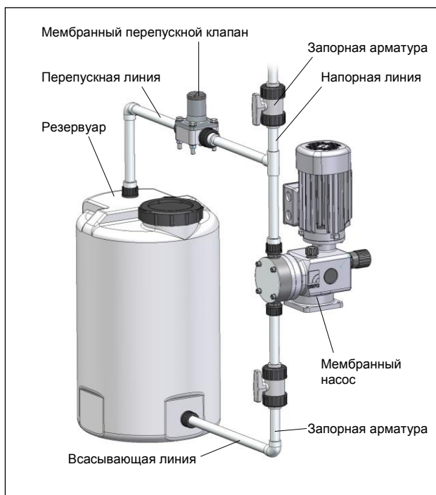
Рис. 22 Монтаж с (внешним) перепускным клапаном
