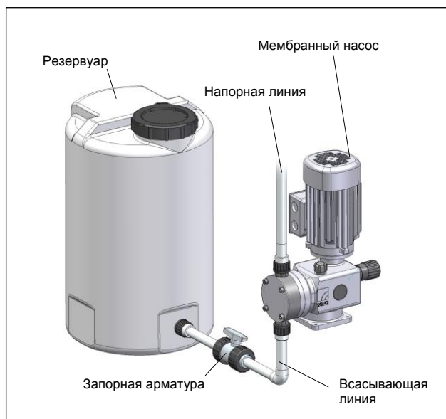
Рис. 33 Монтаж с дополнительной подачей
