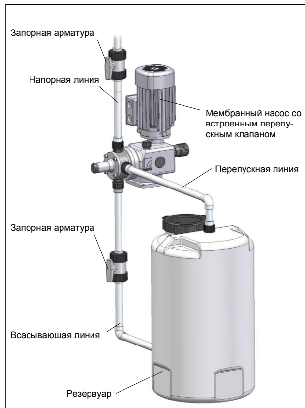
Рис. 23 Монтаж со встроенным перепускным клапаном
