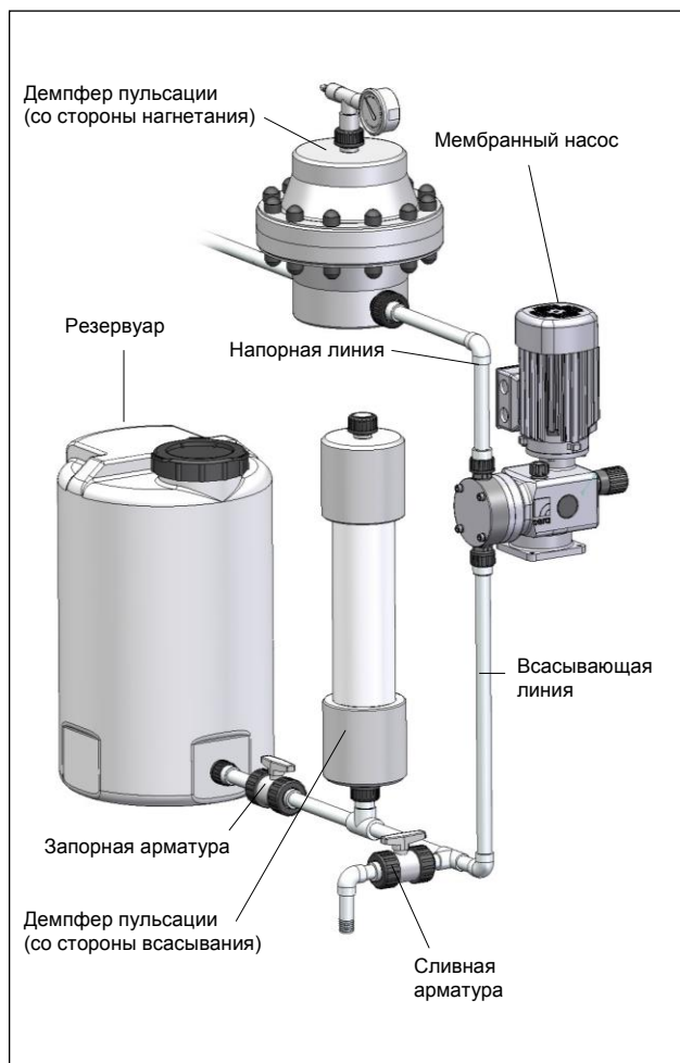
Рис. 37 Монтаж демпфера пульсации (III)
