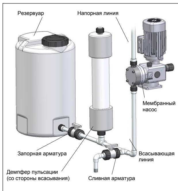
Рис. 36 Монтаж демпфера пульсации (II)
