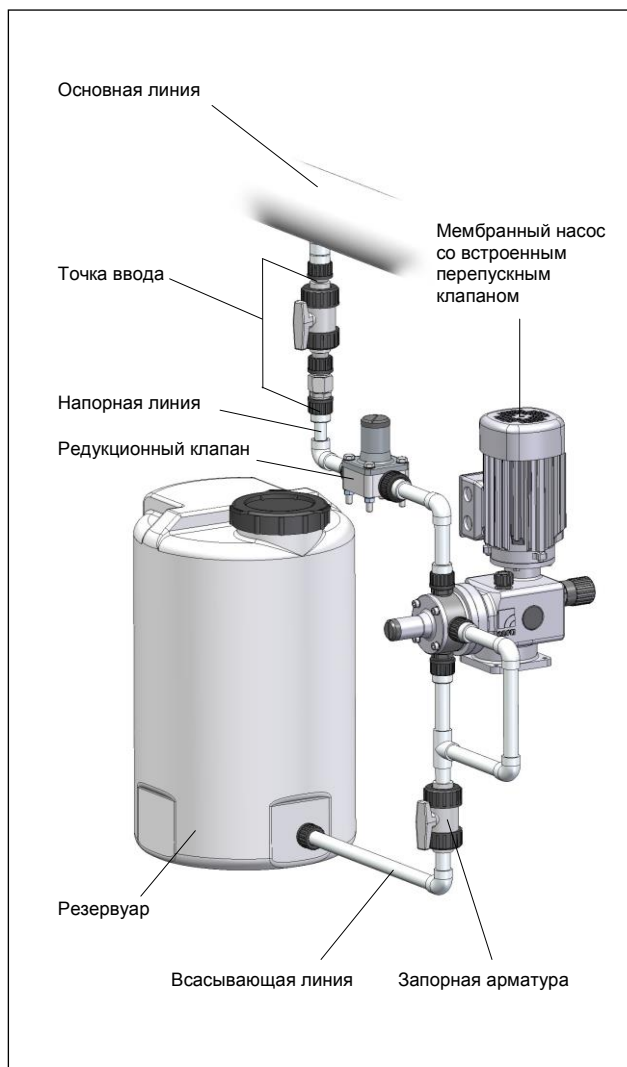
Рис. 27 Монтаж редукционного клапана
